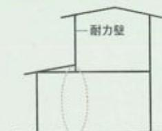
2階の耐力壁の下に1階の耐力壁を設置して、力を無理なく伝えることができます。
