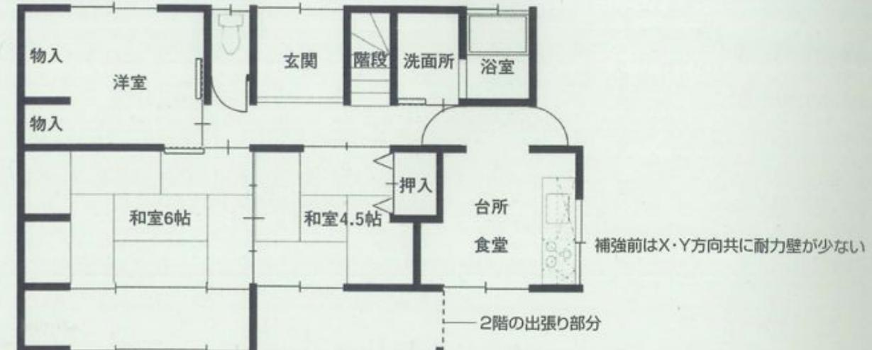
**補強後 1階平面図**
